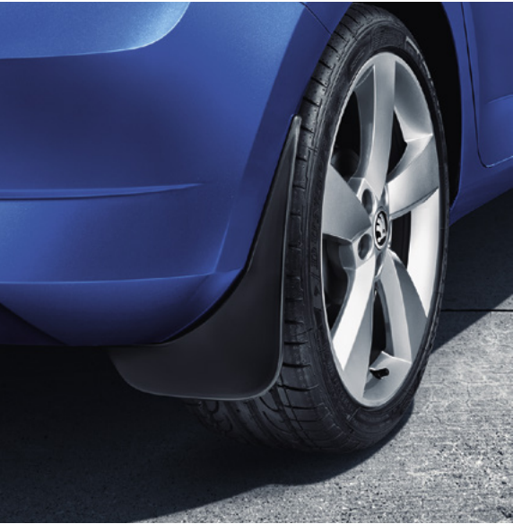
GARDE-BOUE Les garde-boue arrière protègent le châssis de la boue et des pierres volantes.
