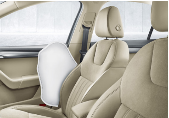
AIRBAGS LATERAUX AVANT ET ARRIERE Ces quatre airbags protègent le bassin et la poitrine du conducteur et des autres passagers en cas de collision latérale.
