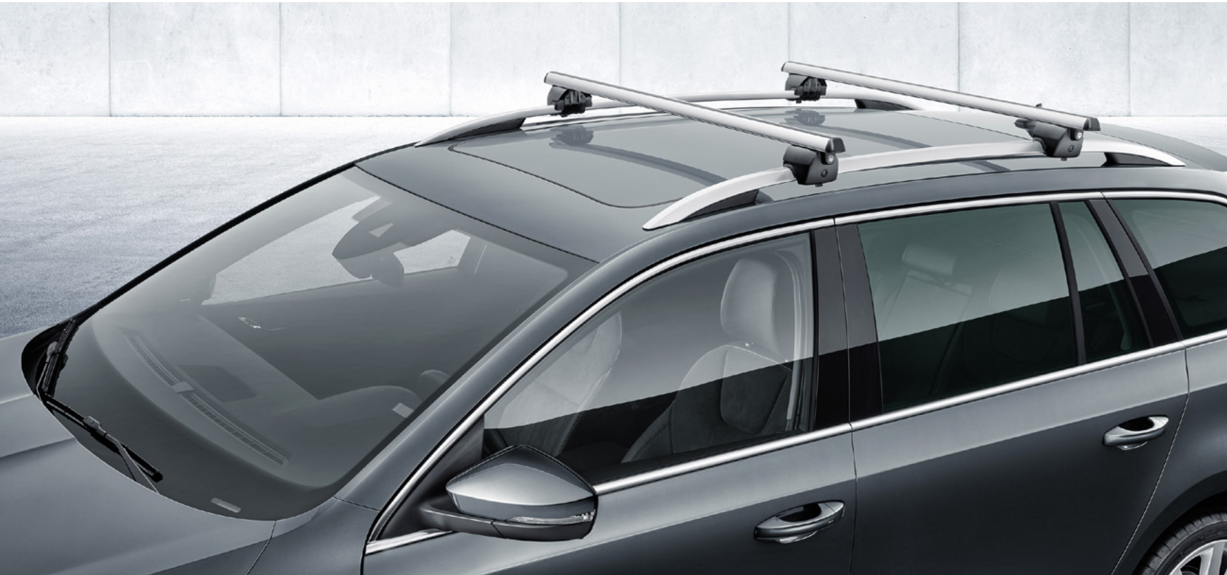
BARRES DE TOIT Fixées aux rampes de pavillon, les barres de toit transversales (pour la version Combi) vous permettent de fixer en toute sécurité d'autres galeries et supports de la gamme d'accessoires d'origine ŠKODA, comme un porte-vélos, coffre de toit, porte-skis ou snowboards.
