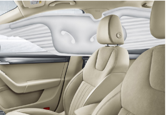
AIRBAGS DE TETE Lorsqu'ils sont activés, les airbags de tête forment un mur, qui protège les occupants avant et arrière de toute blessure à la tête.
