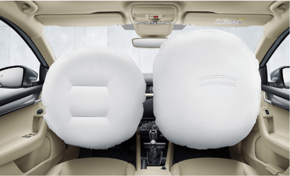
AIRBAGS CONDUCTEUR ET PASSAGER Tandis que l'airbag conducteur est intégré dans le volant, l'airbag passager se trouve dans le tableau de bord. En cas de besoin, celui-ci peut être désactivé si vous installez un siège enfant sur le siège passager avant.
