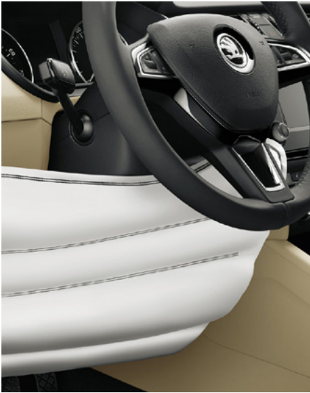
AIRBAG GENOUX Cet airbag, situé sous la colonne de direction, protège les genoux et les tibias du conducteur.
