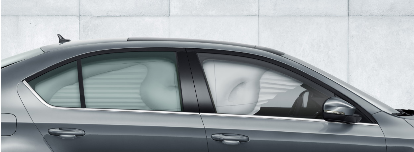
AIRBAGS DE TETE Lorsqu'ils sont activés, les airbags de tête forment un mur, qui protège les occupants avant et arrière de toute blessure à la tête.
