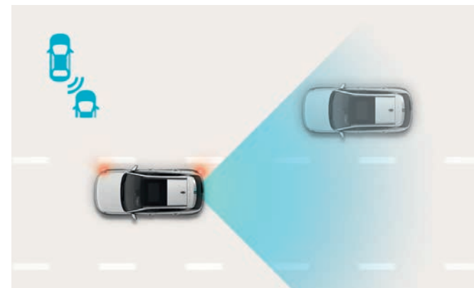
Surveillance active des angles morts avec assistance active au changement de voie.
