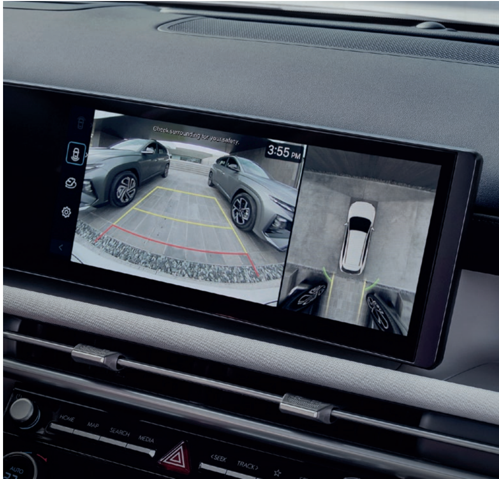
Caméra de recul avec lignes de guidage dynamiques / Caméra 360° avec vue 3D
