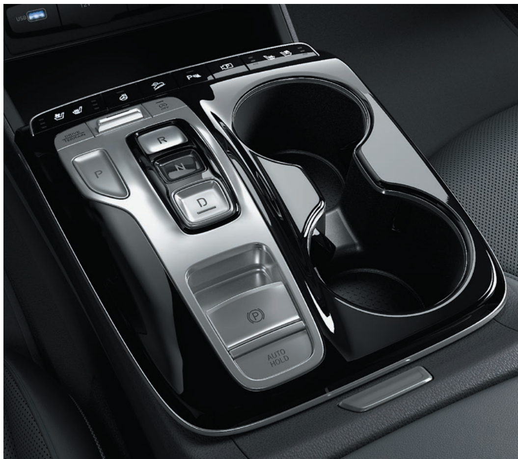
Transmission à commande électrique.
