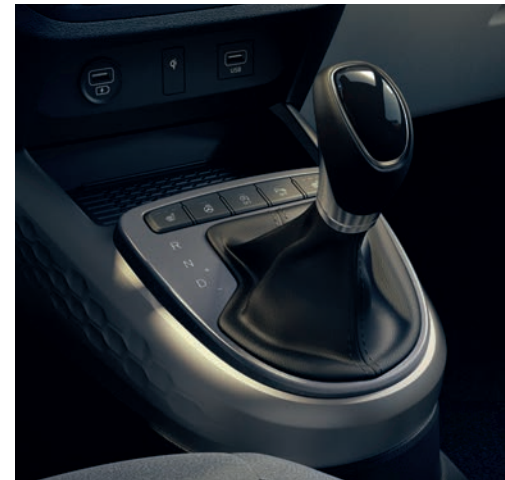
Boîte de vitesses robotisée, 5 rapports
