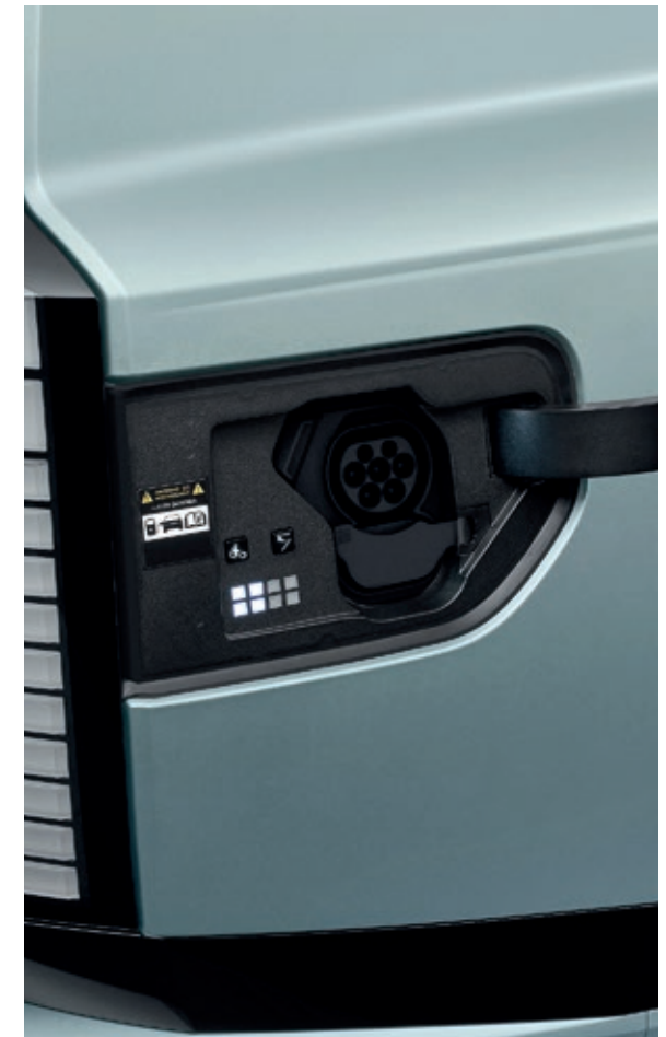
Trappe de recharge électrique
