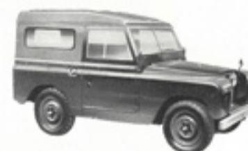
Châssis court équipé d'un toit métallique amovible avec fenêtres latérales. Disponible pour l'exportation seulement (supplément).
