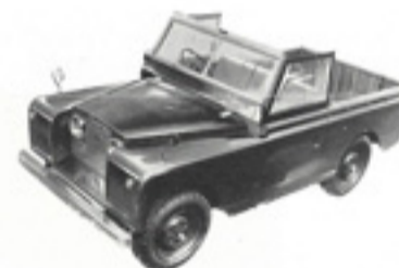
Châssis court avec bâche démontée.
