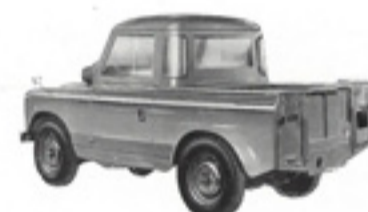
Châssis court équipé de la cabine avant en tôle (supplément).
