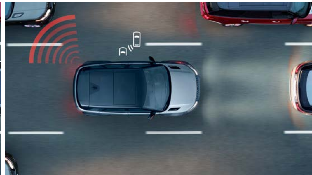
Système de surveillance des angles morts avec assistance active
