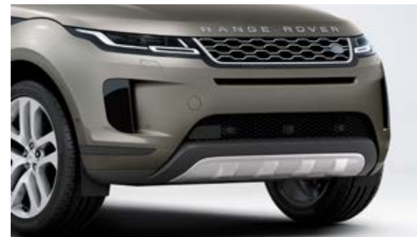
Tôle de protection inférieure en acier inoxydable – Avant
