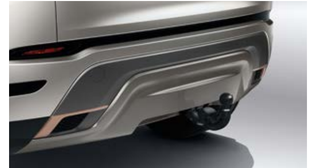
Crochet d'attelage déployable électriquement
