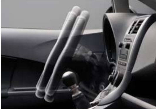
Colonne de direction réglable
