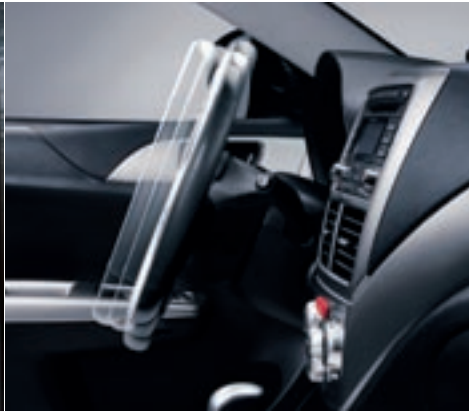
Colonne de direction réglable dans 4 directions
