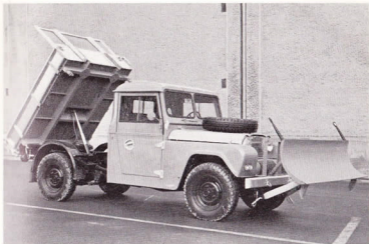
Geländegängiges Nutzfahrzeug für Kommunalbetriebe EFAG-Aufbau
