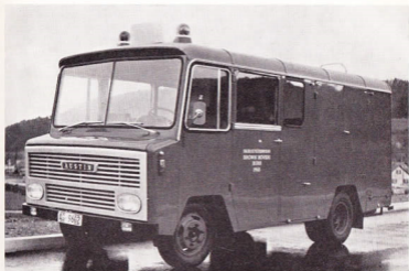
Motor: 6 Zylinder, 4 Liter, Benzin EFAG-Aufbau
