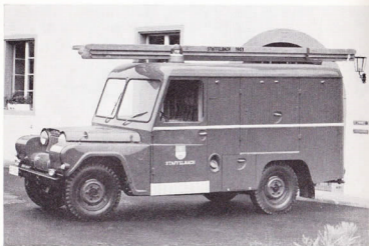
Allradangetriebener Feuerwehr- pikettwagen EFAG-Aufbau
