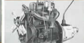
Le moteur de 1000 cc à 4 cylindres à soupapes en tête développe 40 CV à 4300 tours/minute.
