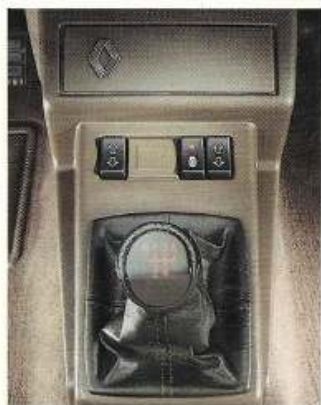
Comando dos elevadores de vidros eléctricos e da abertura electromotorizada das portas.
