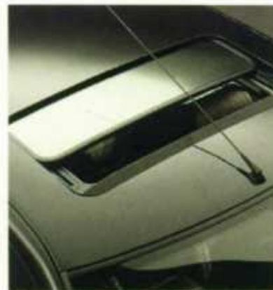
Elektrisch bedienbaar zonnedak met wegschuifbare hemelbekleding.
