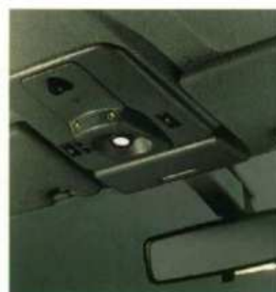
Dakconsole met kaartleeslampje en ontvanger van het alarm-systeem
