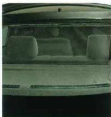
Zonwering achterraut geïntegreerd in de hoedenplank.
