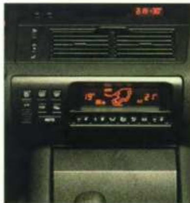
Airconditioning met elektronische temperatuurregeling.
