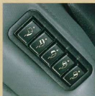
5-voudige fijnafstelling van de «Ergomatic» voorstoelen
