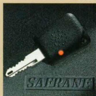
Infrarood afstandsbediening van de portieren, de achterklep en de tankdopklep
