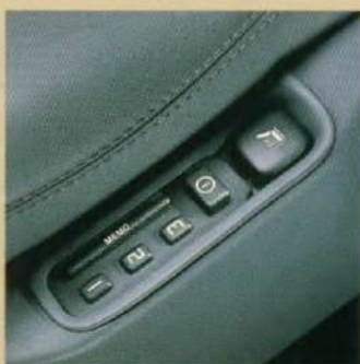
Memory-systeem - instelling geheugen bestuurdersstoel en bediening verwarmbare zitting
