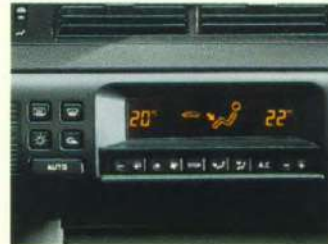
Door de «zonneshijn»-toets houdt de airconditioning automatisch rekening met extra zonnige omstandigheden.
