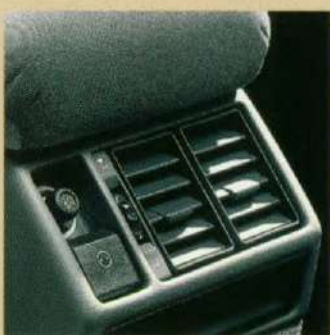
Ventilatoroosters, aansteker en accessoire-aansluiting achter
