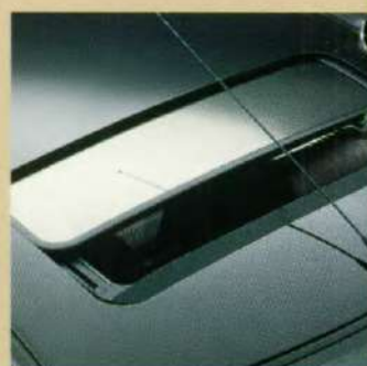
Elektrisch bedienbaar glazen schuifkanteldak met wegschuifbare hemelbekleding
