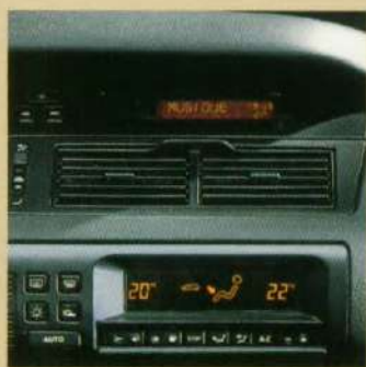
Elektronisch geregelde airconditioning, links/rechts apart instelbaar en «zonneschijm»-toets
