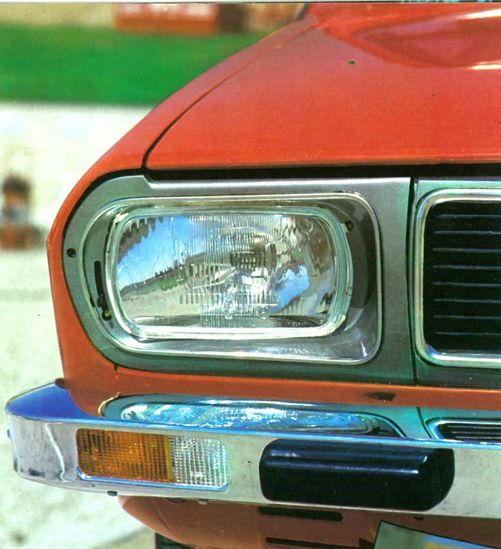
Faros regulables en altura. Pilotos encastrados.
