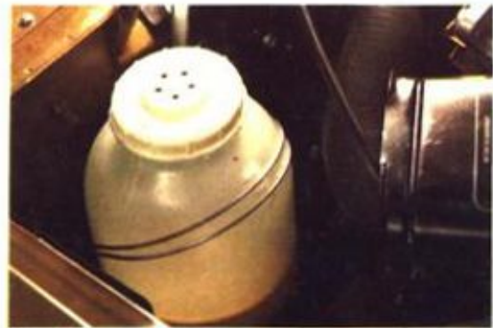
Circuito de enfriamiento con vaso de recuperación.
