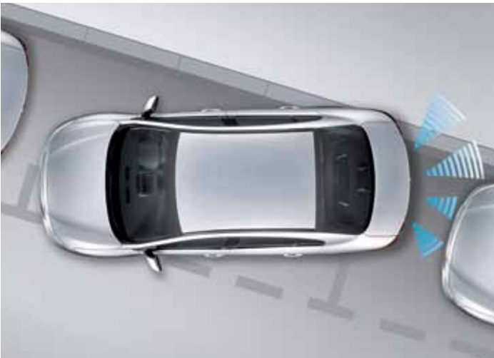
Por meio de sinais sonoros, os sensores de estacionamento traseiros permitem identificar a presença de obstáculos durante as manobras*.
