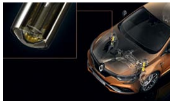
Amortisseurs avec 4 butées hydrauliques de compression
