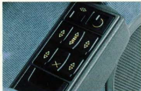
Bedieningspaneel elektrische ruiten en spiegels.
