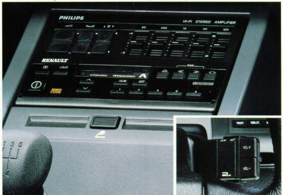
4 x 20 Watt stereo-installatie met bedieningssatelliet.
