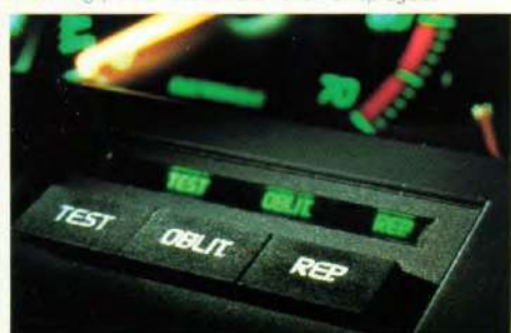
Bedieningspaneel van het sprekende dashboard.
