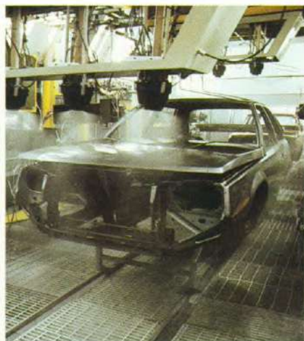
Het automatisch spuiten van laklagen
