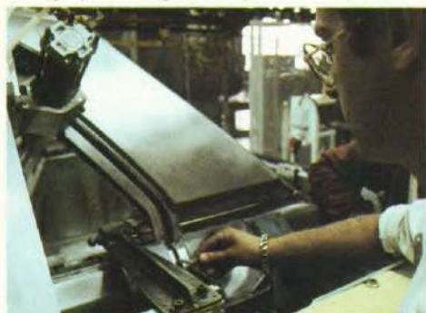
Controle van de toleranties op 90 punten
