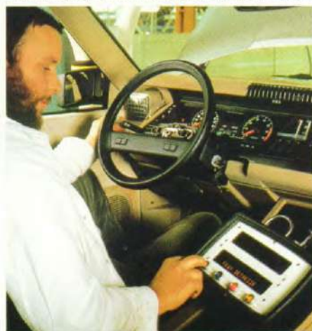
Geprogrammeerde controle van de elektrische functies
