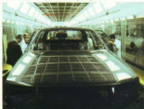
Controle van afdichting vóór het bekleden
