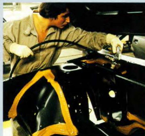
Het gladstrijken van de mastiek
