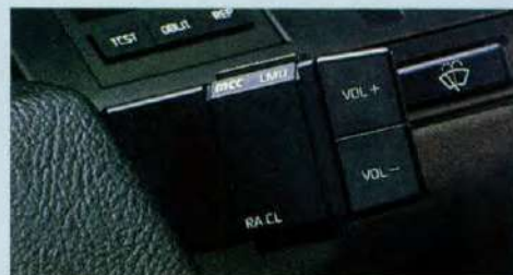
Bediening van de radio vanaf het stuur.
