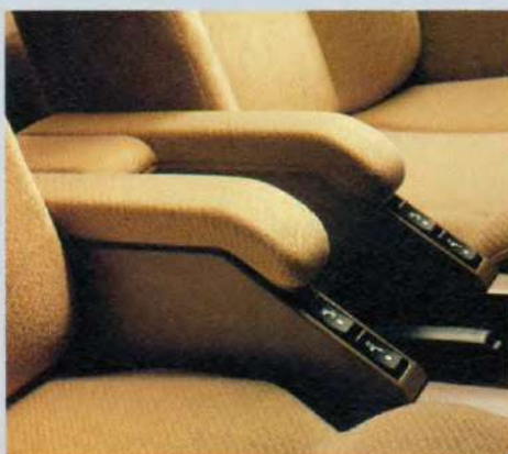
Centrale armsteun met elektrische bediening van de voorstoelen
