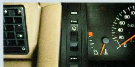
Het op nul zetten van de boordcomputer
