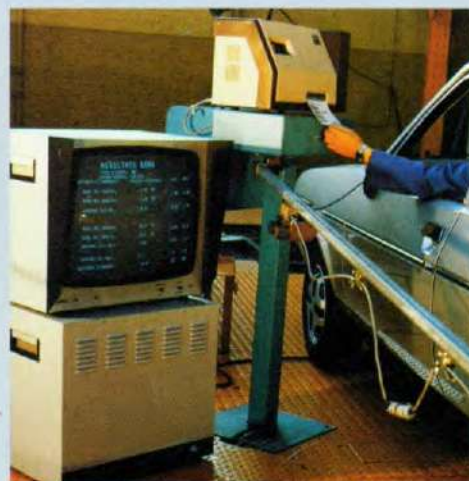
Geprogrammeerde controle van de elektrische functies
