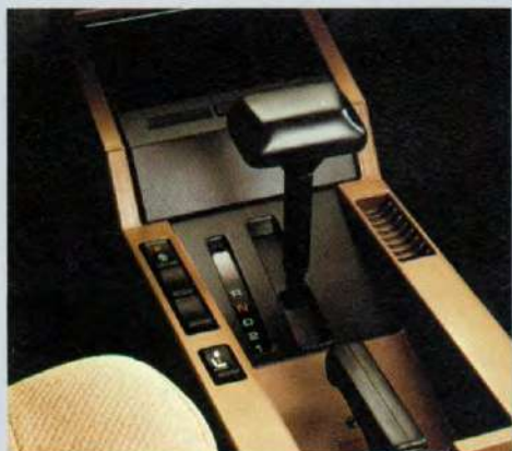
Centrale armsteun met elektrische bediening van de voorstoelen
