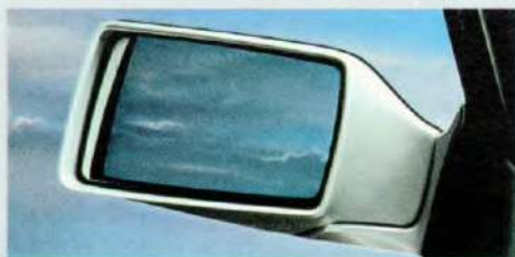
◀ Elektrisch verwarmde en instelbare buitenspiegel aan de kant van de bestuurder.
