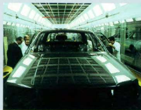
Controle van afdichting vóór het bekleden
