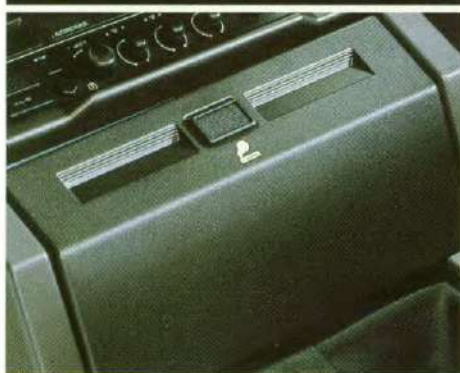
Hydraulisch bediend deksel van de asbak.
