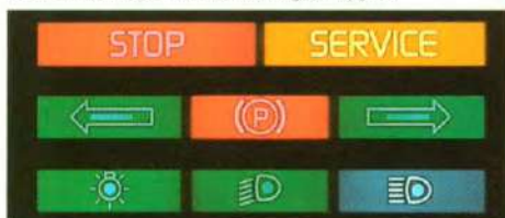
Centraal instrumentenpaneel met waarschuwings- en alarmeringslampjes.
