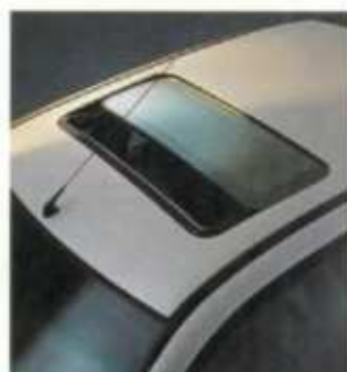
Elektrisch bedienbaar glazen schuifdak, gedeeltelijk geopend.
