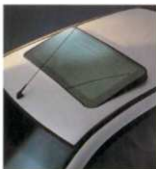
Elektrisch bedienbaar glazen schuifdak, gekanteld.
