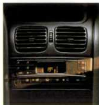
Elektronisch geregeld systeem voor klimaatbeheersing, inclusief airconditioning, en microfilter.
