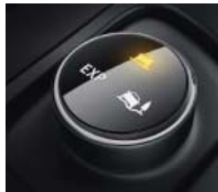
Unverzichtbar für das Vorankommen auf schwierigem Untergrund wie Matsch oder Sand. Das Extended Grip System steuert Drehmoment und Antischlupfregelung für optimale Traktion. Umschaltbar zwischen „Normal-“, „Gelände-“ und „Expert-Modus“ – je nach Fahrbedingung.
