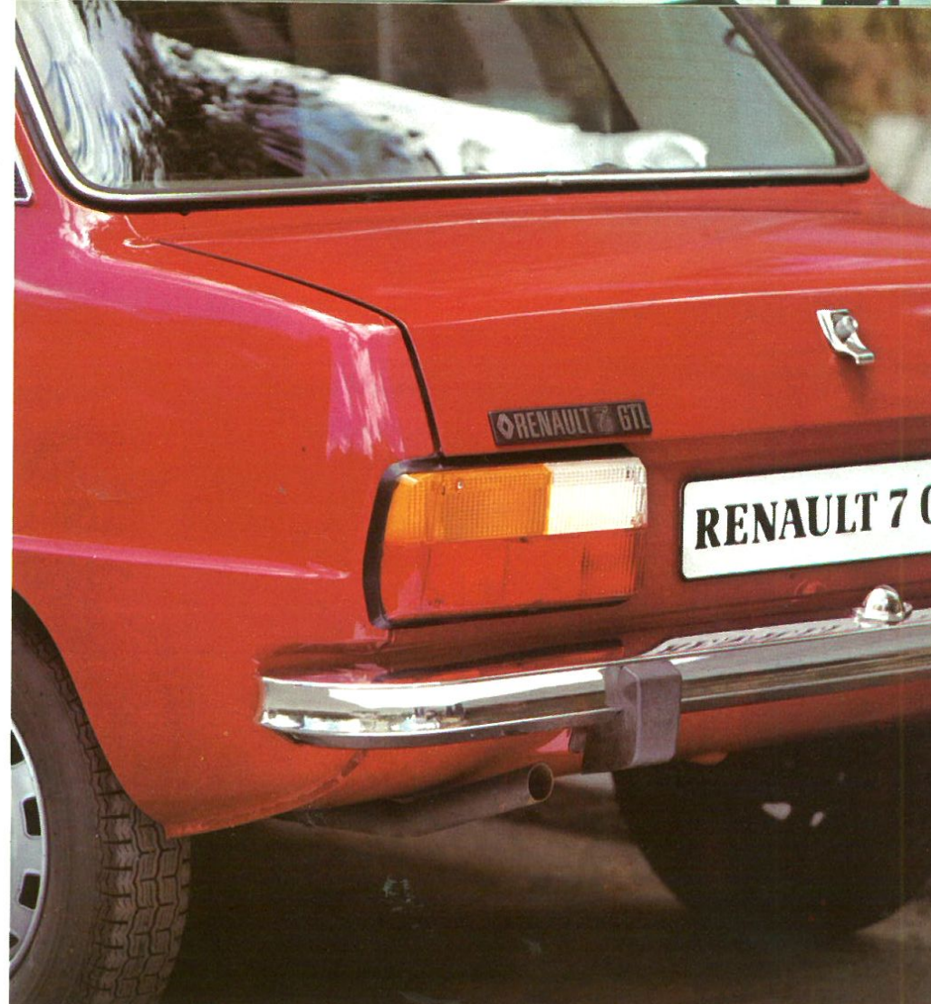
Pilotos traseros muy visibles con luz de marcha atrás.
