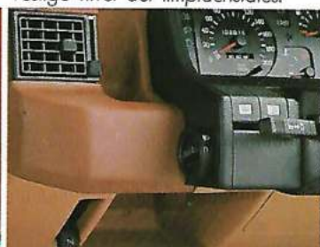
Regulación interior de faros.
