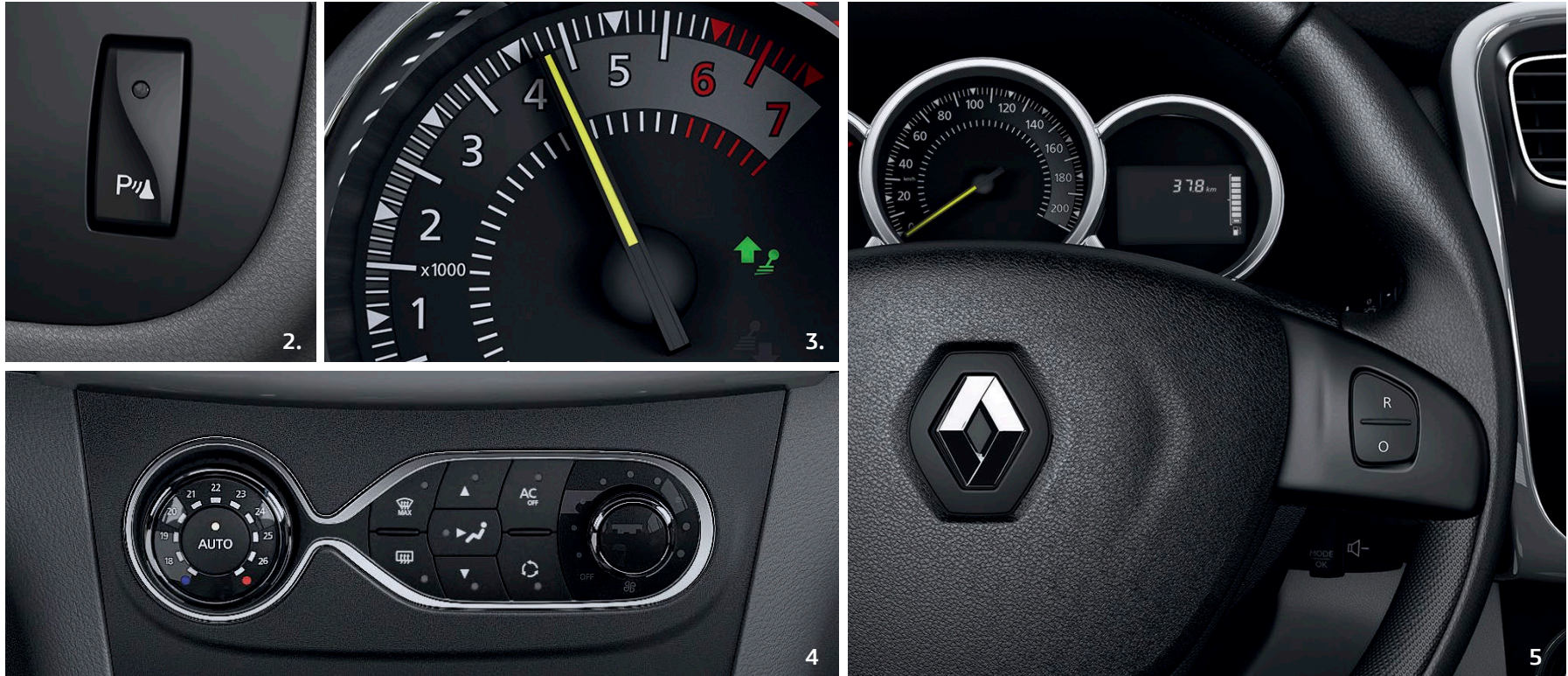
1. Centro multimedia Media Nav® 100% touch, pantalla táctil de 7", sistema GPS, manos libres para celulares y un reproductor multimedia enlazable con dispositivos portátiles mediante puerto USB o Bluetooth®. 2. Sensores de estacionamiento (4) que te informan la presencia de cualquier obstáculo al retroceder. 3. GSI, gear shift indicator. 4. Climatizador. 5. Control de cruceo y limitador de velocidad.
