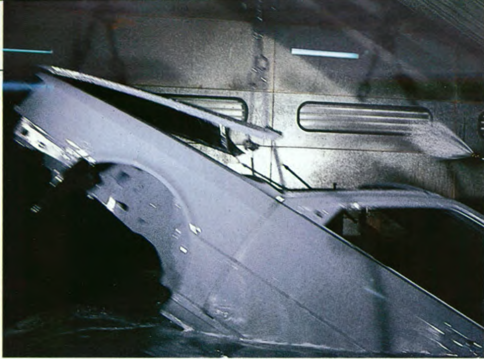
Robots lassen de carrosserie
