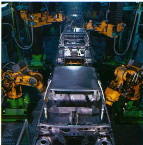
Montage van carrosseriedelen door robots
