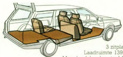
2 zitplaatsen Laadruimte 1710 dm 3 Max. laadvloerlengte 1.745 m
