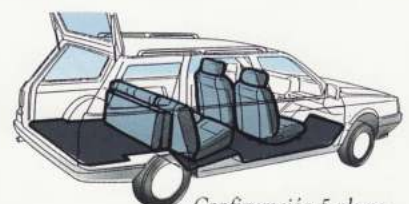
Configuración 5 plazas. Volumen de carga 922 dm 3 . Longitud máxima de carga 1,010 m.
