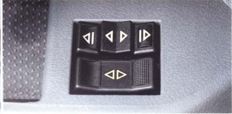
Elevavinas eléctricos delanteros, con impulsión en el lado del conductor.
