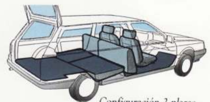
Configuración 2 plazas. Volumen de carga 1.710 dm 3 . Longitud máxima de carga 1,745 m.
