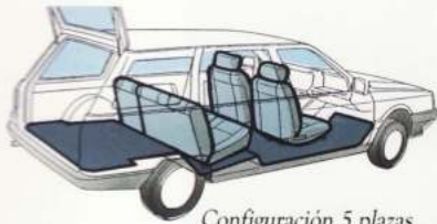
Configuración 5 plazas. Volumen de carga 674 dm 3 . Longitud máxima de carga 1,146 m.
