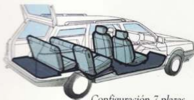
Configuración 7 plazas. Volumen de carga 338 dm 3 . Longitud máxima de carga 0,580 m.
