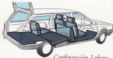
Configuración 3 plazas. Volumen de carga 1.399 dm 3 . Longitud máxima de carga 1,745 m.
