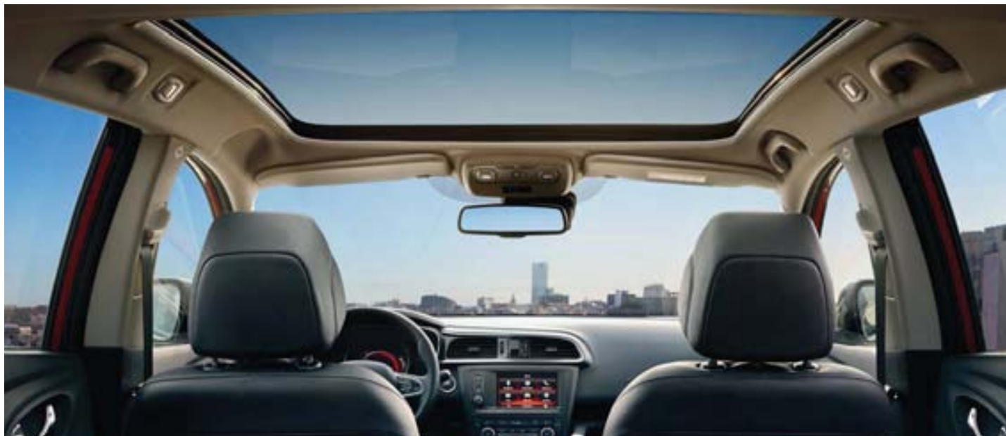
Toit en verre fixe et rétroviseur intérieur électrochrome
