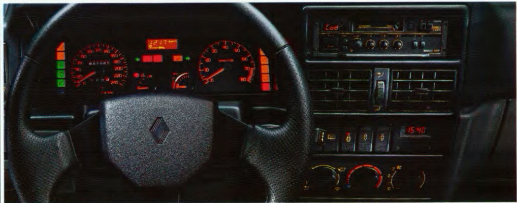
Dashbord Renault 19 Chamade 16V met extra 4 x 6 W radio en boordcomputer.
