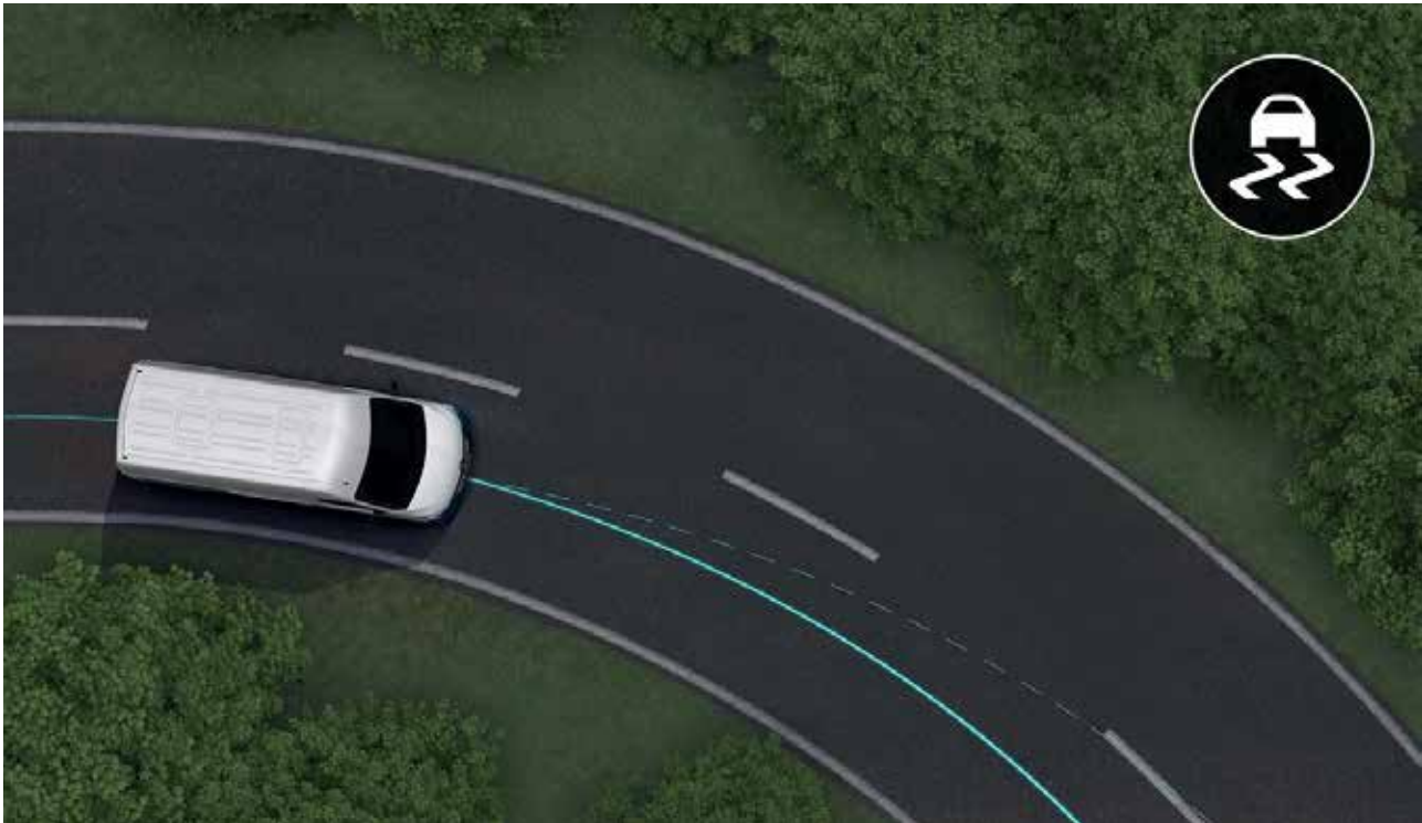
control de estabilidad (ESP) El ESP permite corregir la trayectoria del vehículo para evitar deslizamientos.
