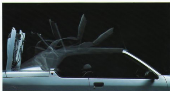
Cinématique de fonctionnement de la capote.
