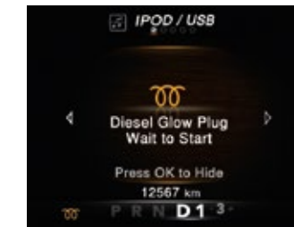
Afficheur des bougies de préchauffage, moteur diesel.
