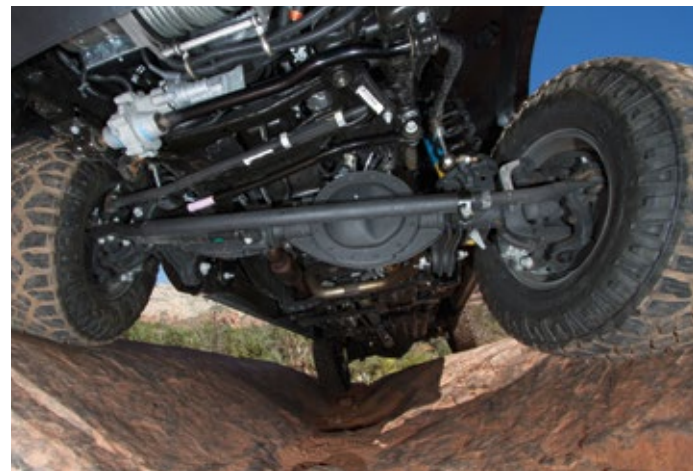
Barre antiroulis avant à désaccouplement électronique.
