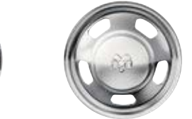
Roues de 17 po en aluminium avec creux peints noir mat et enjoliveur central noir Compris es dans l'ensemble Power Wagon sur le modèle 2500
