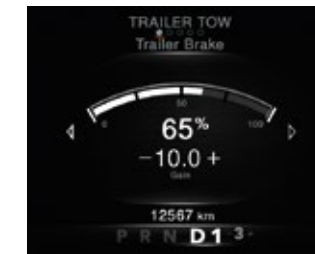
Afficheur du module de commande des freins de remorque.
