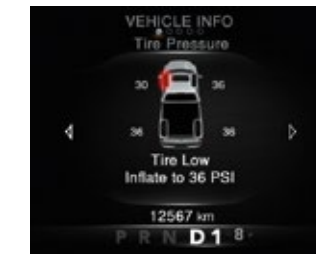
Surveillance de la pression des pneus avec affichage.
