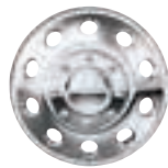
Roues de 17 po en aluminium poli de série sur le modèle Laramie Longhorn (WF9)
