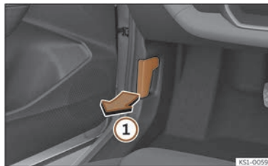
Fig. 192 Lever de déverrouillage sur le plancher, côté conducteur.
