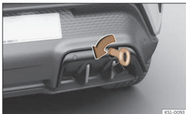
Fig. 188 Du côté droit du pare-chocs arrière : œillet de remorquage vissé.
