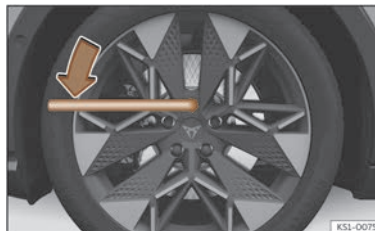
Fig. 204 Changement de roue : desserrer les boulons de la roue.
