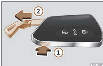
Fig. 66 Clé du véhicule : retirer le panneton.
