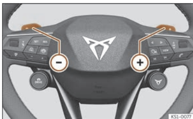
Fig. 103 Volant multifonction : leviers pour la récupération d'énergie.
