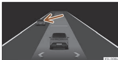
Fig. 119 Sur l'écran du tableau de bord : ACC activé, véhicule circulant à gauche détecté.
