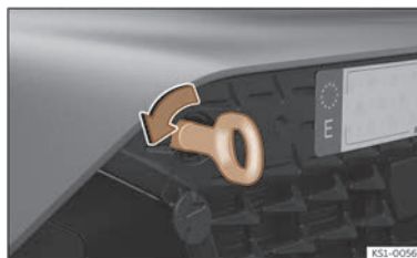
Fig. 186 Partie droite du pare-chocs avant : œillet de remorquage vissé.
