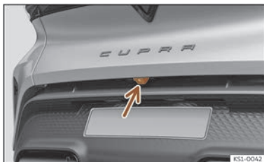
Fig. 113 Sur le pare-chocs arrière : emplacement de la caméra de l'assistant de marche arrière.
