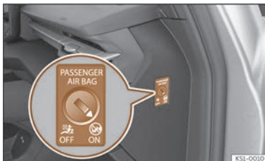
Fig. 27 Commande à clé permettant d'activer et de désactiver l'airbag du passager avant.
