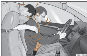
Fig. 20 L'occupant de la banquette arrière non attaché est projeté en avant et vient heurter le conducteur attaché.
