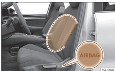
Fig. 31 Airbag latéral sur le siège du conducteur et du passager avant.
