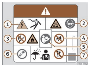
Fig. 51 Étiquette d'avertissement sur la batterie à haute tension.
