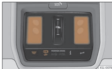
Fig. 93 Détail du revêtement du toit : éclairage avant de l'habitacle.
