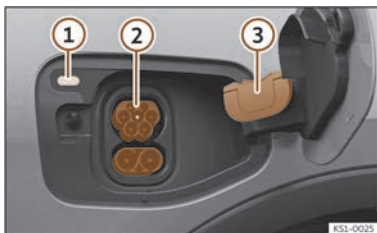
Fig. 57 Derrière la trappe de la prise de charge de la batterie, à l'avant droit : prise de charge.
