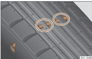
Fig. 199 Sculpture du pneu : indicateurs d'usure.
