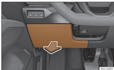
Fig. 189 Sous le combiné d'instruments côté conducteur : couvercle de la boîte à fusibles.
