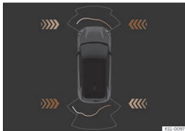
Fig. 124 Sur le système d'infodivertissement : affichage de l'assistant d'intersection.
