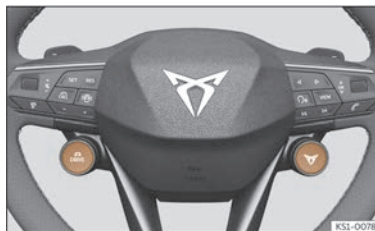
Fig. 106 Volant multifonction : Boutons DRIVE et CUPRA pour sélectionner et changer le profil de conduite.
