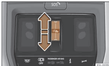
Fig. 99 Sur le revêtement intérieur du toit : bouton de fonction du store pare-soleil.
