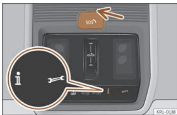
Fig. 46 Sur la console de pavillon : commandes pour les services vocaux.
