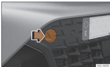
Fig. 185 Du côté droit du pare-chocs avant : retirer le cache.
