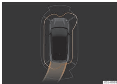
Fig. 136 Affichage du système d'aide au stationnement à l'écran du système d'infodivertissement.
