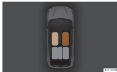
Fig. 18 Tableau de bord : indication de l'état des ceintures de sécurité.
