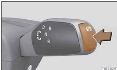
Fig. 134 Sur le sélecteur de vitesses : la touche de frein de stationnement électronique.
