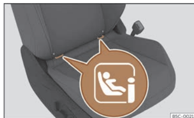
Fig. 38 Siège passager avant : emplacement des anneaux de fixation i-Size.
