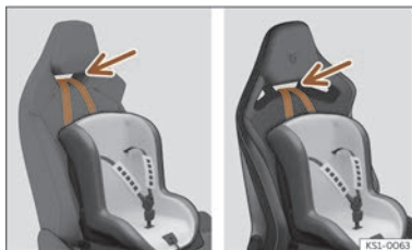
Fig. 43 Siège du passager avant : réglage et montage en fonction de la ceinture Top Tether.
