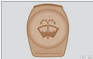
Fig. 197 Dans le compartiment avant : bouchon bleu du réservoir de liquide lave-glace.
