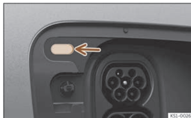
Fig. 58 Sous la trappe de la prise de charge de la batterie : indicateur de l'opération de charge.
