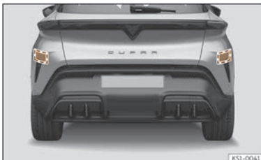
Fig. 111 Vue arrière du véhicule : zones des capteurs radar.
