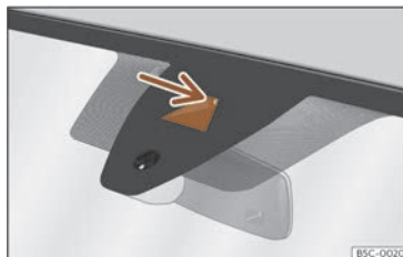
Fig. 110 Sur le pare-brise : aire de champ visuel de l'assistant de maintien de voie.
