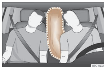
Fig. 30 Airbag central complètement gonflé (zone de déploiement).
