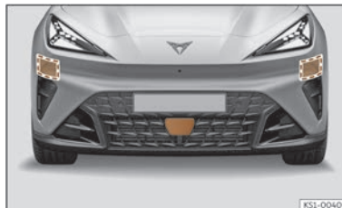
Fig. 108 Dans le pare-chocs avant : capteurs radar avant et latéraux.
