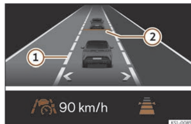
Fig. 126 Sur l'écran du tableau de bord : visualisation avec le régulateur actif (représentation schématique).
