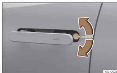
Fig. 75 Poignée de la portière du conducteur : barillet de serrure caché.
