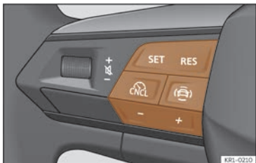
Fig. 114 Sur le volant multifonction : boutons permettant d'actionner le régulateur de vitesse.
