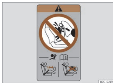
Fig. 36 Autocollant de l'airbag : sur le cadre arrière de la porte passager avant.
