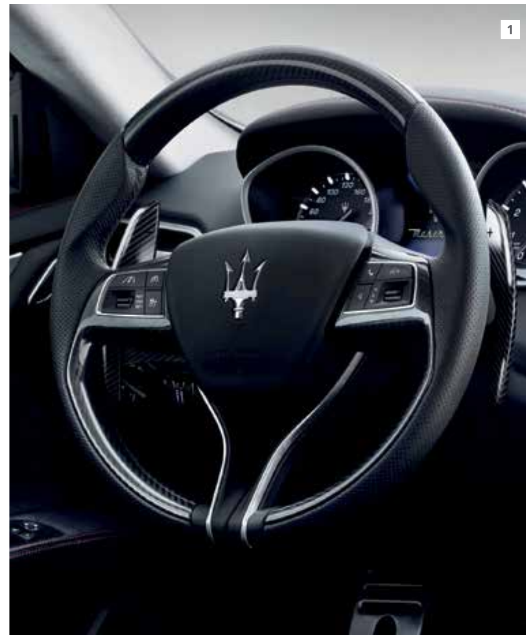
1 - Volant sport avec inserts en fibre de carbone et palettes de changement de vitesses en fibre de carbone.
