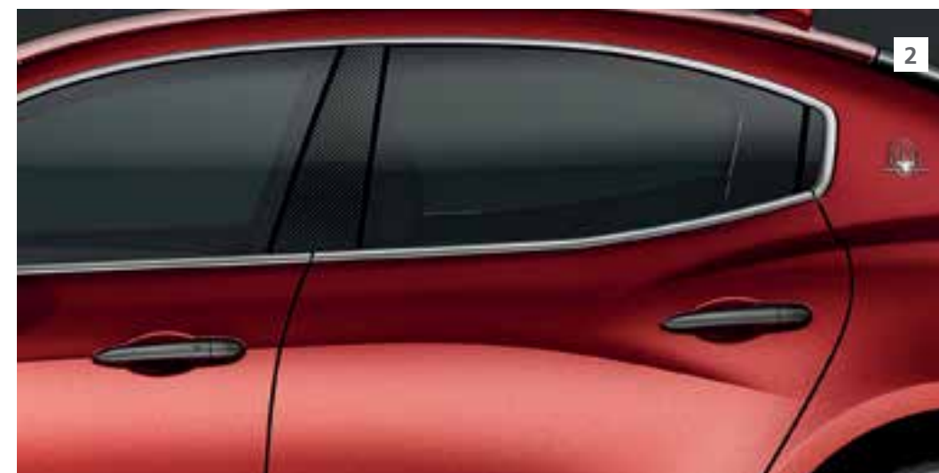
2 - Poignées de portes, montants central et arrière en fibre de carbone.
