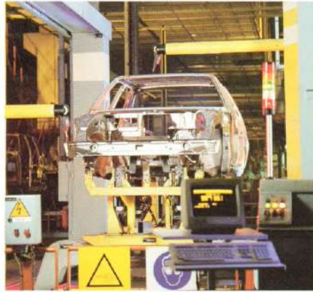
Controle van geometrische afmetingen van de carrosserie.
