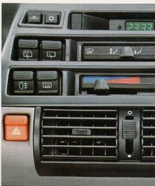
Il condizionatore aria manuale, con funzioni di ricircolo e deumidificazione dell'aria è di serie sulla Suite e a richiesta per la Sporting.
