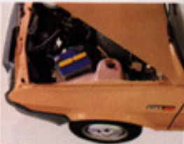
Zweckmässige, an der Karosserie verschraubte Kotflügel.
