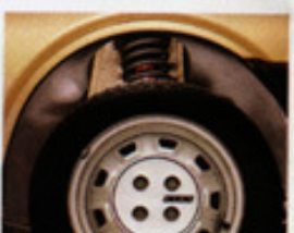
PVC-Beschichtung des Unterbodens und Radkästen.
