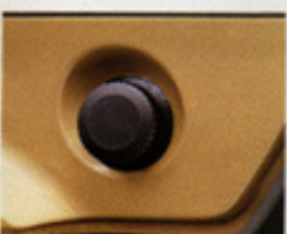
Tankfüllstutzen mit Schutzsieb.
