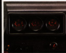
Instrumentenbrett mit Öldruckmesser, Ölthermometer und Voltmeter.
