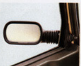
Aussenspiegel mit Sicherheitsgelenk von innen einstellbar.
