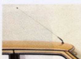
Radioantenne auf dem Dach.
