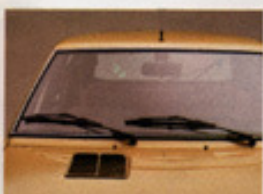
Scheibenwischer mit 2 Geschwindigkeiten plus Intervallbetrieb.
