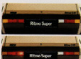
Heckleuchtengruppe mit Nebelleuchte und Warnblinkanlage.
