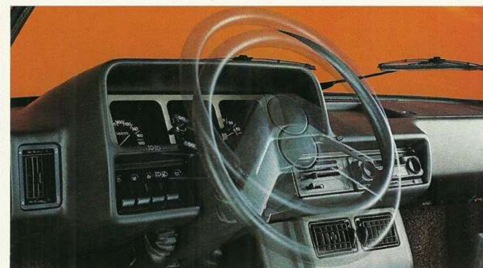
Höhenverstellbares Lenkrad: Fahrerposition nach Mass.
