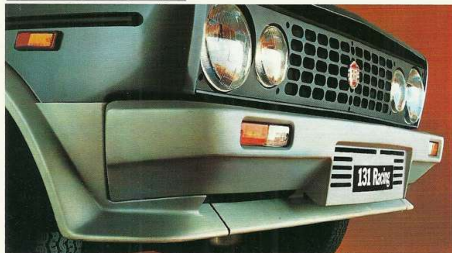
Frontspoiler mit den Stosstangen eine Einheit. Geringerer Luftwiderstand, bessere Bodenhaftung bei hohen Geschwindigkeiten.
