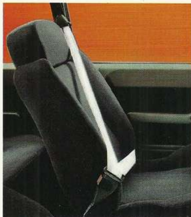
3 Punkt-Sicherheitsgurte mit Aufrollvorrichtung. Komfort und Sicherheit.
