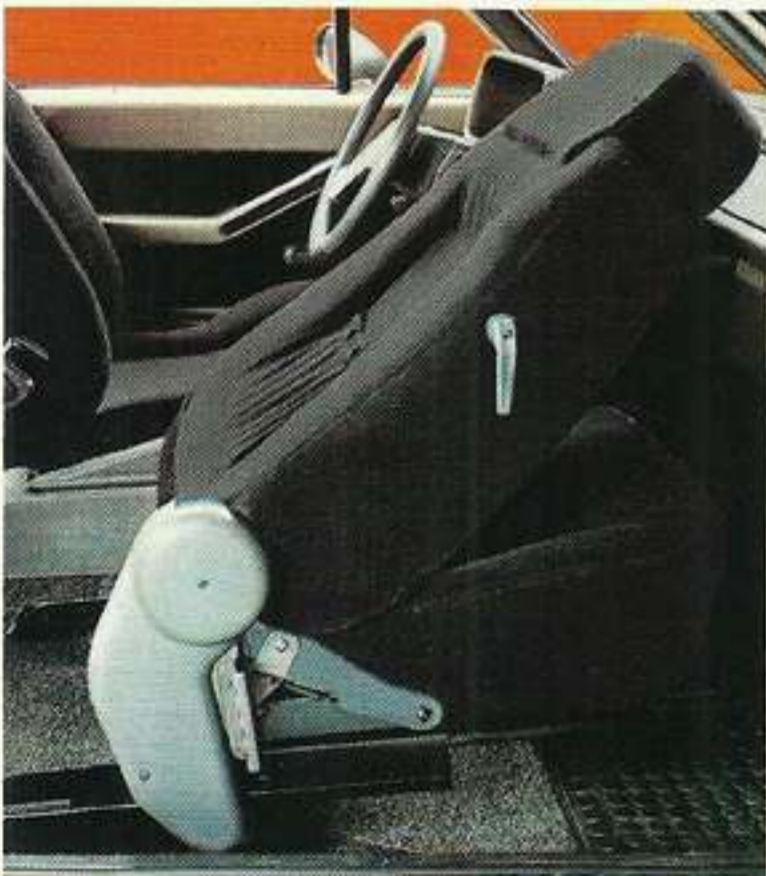
Beim Vorklappen der Lehne gleiten die Vordersitze automatisch nach vorn. Angenehmer Einstieg nach hinten.
