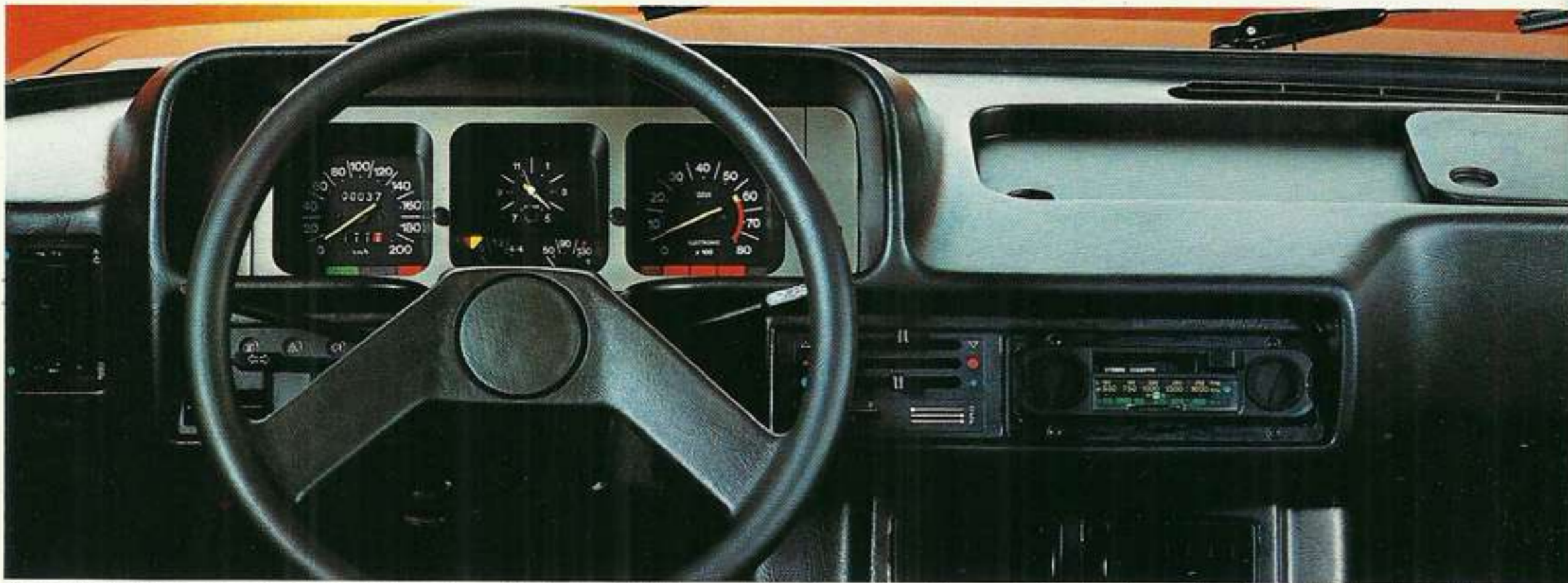
Armaturenbrett aus stossabsorbierendem Material. Mit kompletter Instrumentierung. Geräumiges Handschuhfach mit Schiebeverschluss. Zweispeichenlenkrad mit griffigem Material umschäumt: sicher und sportiv.
