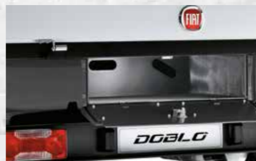
COMPARTIMENT EXTÉRIEUR AVEC SYSTÈME DE VERROUILLAGE POUR STOCKER DES OUTILS DE 2 MÈTRES DE LONG
