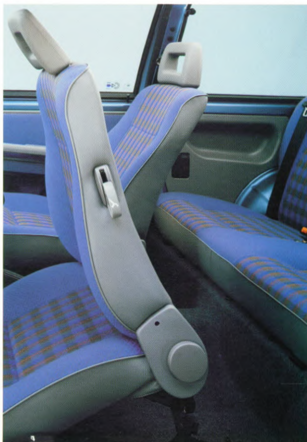
Het ontgrendelingssysteem van de voorstoelen maakt de achterbank gemakkelijk bereikbaar
