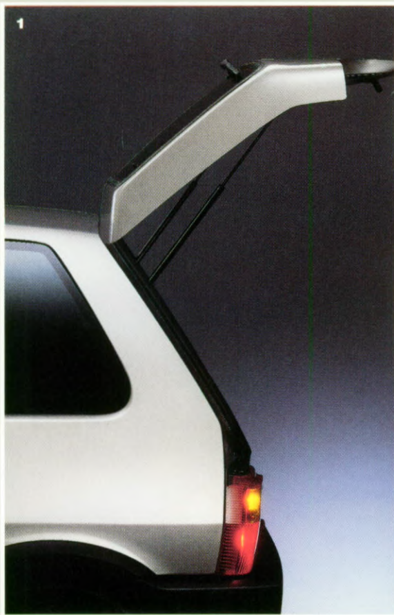
1. Achterklep van dubbel verzinkt plaatwerk, met wijde openingshoek en in evenwicht gehouden door hydraulische dempers.
