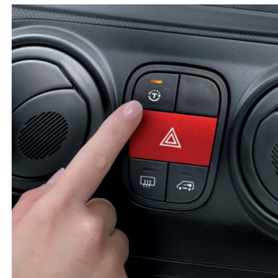
Il Traction+ ottimizza la trazione in fase di accelerazione a bassa velocità.
