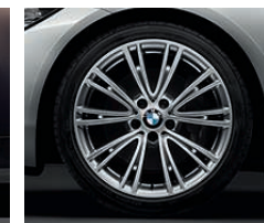
Jantes en alliage léger BMW Individual 19" (48 cm) style 626 I à rayons en V 1 , avec inscription discrète « BMW Individual » et monte pneumatique mixte. Dimensions : 8 J x 19 à l'avant, pneumatiques 225/40 R 19 ; 8,5 J x 19 à l'arrière, pneumatiques 255/35 R 19.
