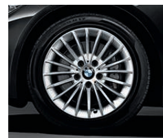
Jantes en alliage léger 17" (43 cm) style 414 à rayons multiples. Dimensions : 7,5 J x 17, pneumatiques 225/50 R 17 (uniquement en combinaison avec la Finition Luxury, de série sur BMW 316i, 320i, 316d, 318d et 320d).
