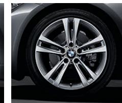
Jantes en alliage léger 18" (46 cm) style 397 à rayons doubles. Dimensions : 8 J x 18, pneumatiques 225/45 R 18 (uniquement en combinaison avec la Finition Sport, de série sur BMW 328i, 335i, 325d, 330d et 335d xDrive).
